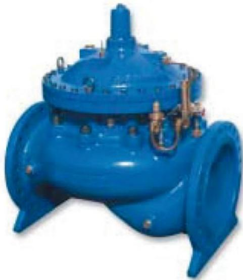
Las válvulas de control Serie 700 de 24, 28, 30 y 32 pulgadas de BERMAD son válvulas de operación hidráulica, activadas por diafragma. La válvula consiste en dos componentes principales: el conjunto del cuerpo y el actuador. El actuador, que se desmonta como una sola pieza integral, comprende dos cámaras de control, una superior y una inferior. El actuador puede convertirse del método de cámara doble al de cámara única.
