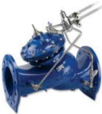
La válvula sostenedora de presión diferencial modelo 736-ES-VI es una válvula de control de operación hidráulica, activada por diafragma, que mantiene una mínima diferencia de presiones predefinida entre dos puntos, independientemente de las fluctuaciones en los caudales o en las presiones aguas arriba.
